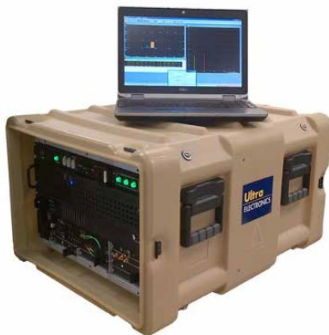
Ilustración 8. Sistema ELINT UltraEAGLE portátil
