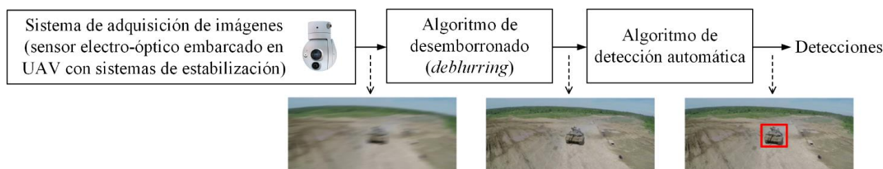
Figura 3. Esquema de la cadena de proceso típica que incluye el desemborronado de la imagen ( deblurring ) y la detección automática de objetos.
